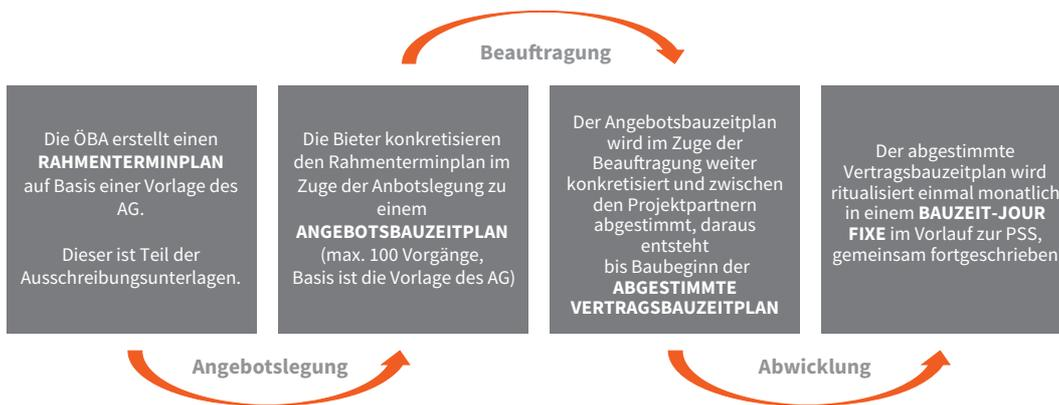
**Abbildung 4:** Schematische Darstellung der standardisierten Bauzeitverfolgung
